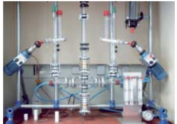
Laborapparatur, mit der Versuche zur Gasreinigung mit dem Mira-Cat-Verfahren durchgeführt werden können.
